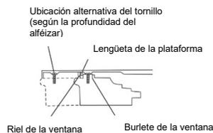
Centre el montaje de la plataforma en la línea, con la lengüeta presionada contra el riel de la ventana.
