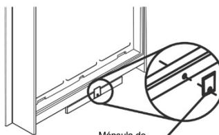
**NOTA:** La ménsula evita que el aire acondicionado se mueva (hacia adentro o hacia afuera) una vez instalado.
