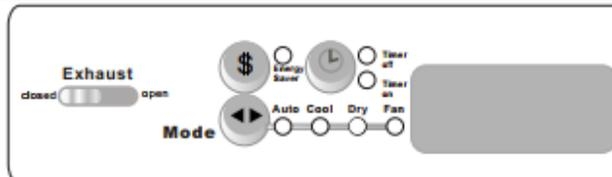
El control de salida permite que el aire acondicionado haga circular aire en el interior (Closed [Cerrado]) o expulse el aire hacia el exterior (Open [Abierto]).
