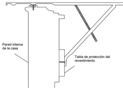
**6. Ubique el montaje,** con la lengüeta de la plataforma contra la parte interna del riel, y sujételo al marco interior de la ventana. Utilice tornillos con una longitud adecuada (las piezas 9 a 11 en Prepárese para la instalación).
