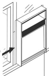
**17. Enganche la ménsula de seguridad** sobre la base de la unidad y sujételo a la parte frontal de la plataforma. Utilice un tornillo autorroscante de 3/4" (19 mm).
