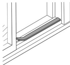
**5. Con precaución, coloque una tabla de protección del revestimiento en el costado de la casa.**
