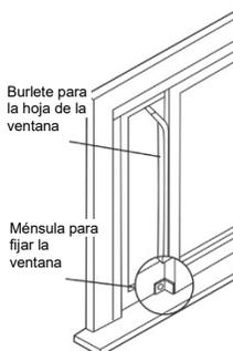
**19. Utilice la ménsula de fijación para fijar la hoja interna de la ventana a la base de la hoja externa.** Use un tornillo de 3/4" (19 mm) o un tornillo autorroscante de la misma longitud (perfore un orificio guía de 1/8" [3,2 mm]).
