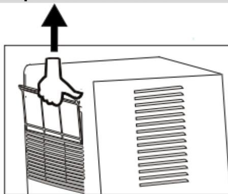
Debe revisar el filtro de aire al menos una vez por mes para determinar si hace falta limpiarlo. Las partículas atrapadas en el filtro se pueden amontonar y provocar la acumulación de hielo en los serpentines de refrigeración.
