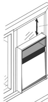
Mida la altura interna desde el marco del panel hasta el extremo superior del equipo.
